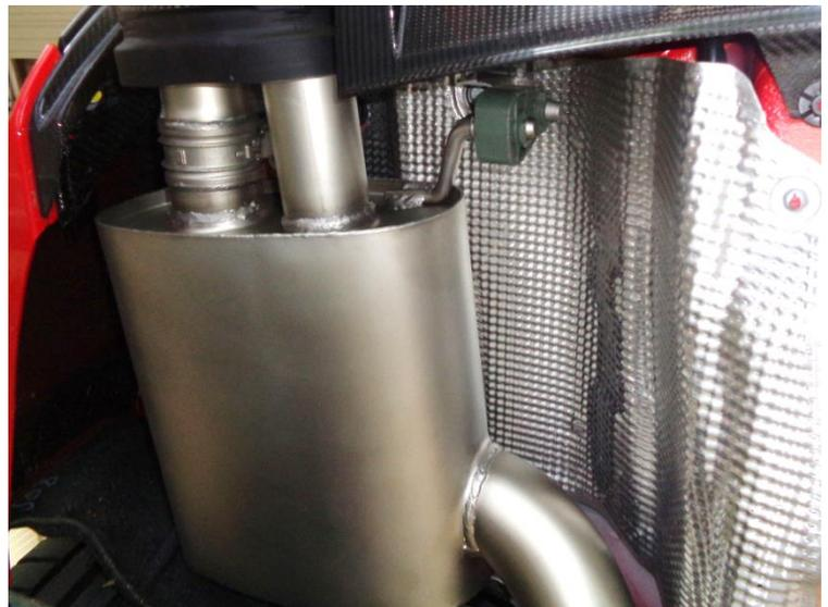
Die REMUS Endrohre auf die REMUS Sportschalldämpfer aufschieben, ausrichten und montieren. Die Querstrebe wieder montieren.
